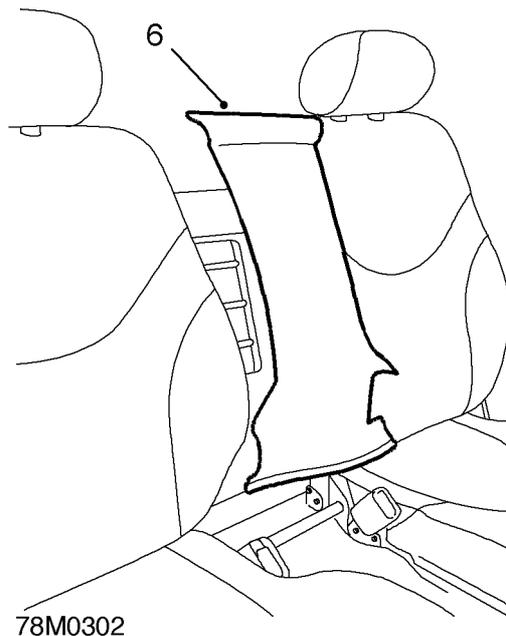
6. Rücklehnenplatte von Rücklehnenrahmen lösen und Rücklehnenplatte entfernen.
